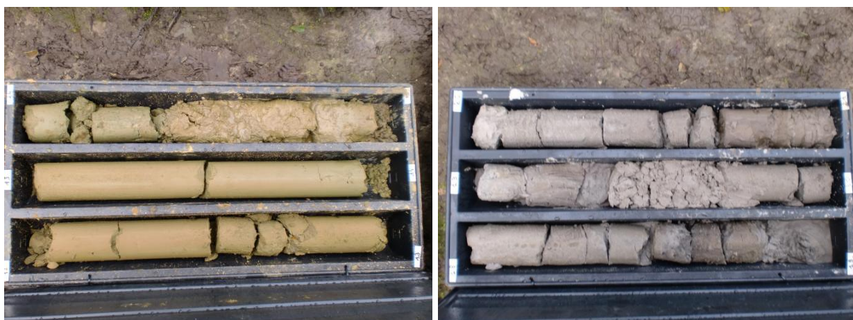
Figure 8 : carottes issues du site du pilote (à gauche : entre 12 et 15 m / à droite : entre 18 et 21 m)
