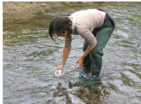
de la surface. Certains paramètres ont été mesurés *in situ* à l'aide d'une sonde multiparamétrique de type « Aqualyse professionnel plus » préalablement étalonnée. C'est le cas de la température, du pH, de la conductivité, de l'oxygène dissous et de la saturation en oxygène, des paramètres susceptibles d'évoluer lors du transport de l'échantillon d'eau.
