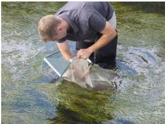
Photographie 6 : Prélèvement au filet surber
