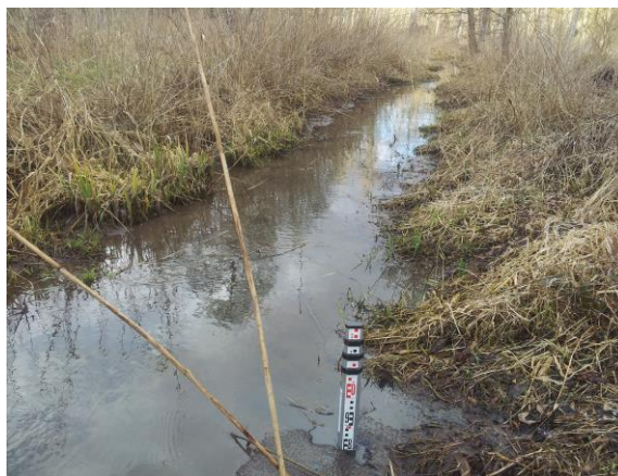
Engorgement sur le ru Noir en amont : 0.8m de vase mesuré à la mire
