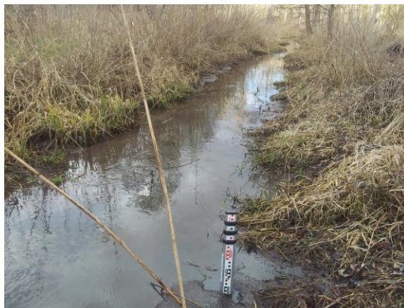
Envasement sur le ru Noir en amont : 0.8m de vase mesuré à la mire
