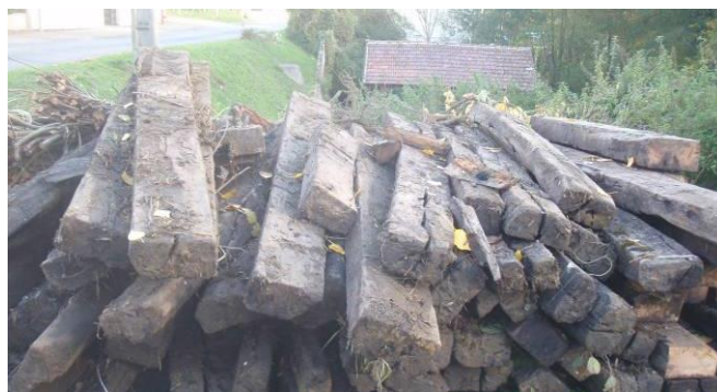
Photo 5 : Traverses de chemin de fer avant évacuation en déchetterie spécialisée
